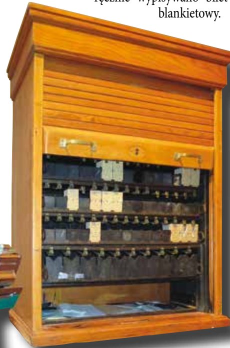
Komposter do datowania biletów przez kasjera w kasie biletowej (po lewej) oraz ternion z biletami kartonikowymi.
