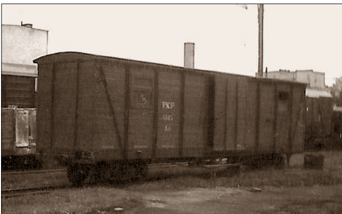
Jedynе znane zdjęcie jednego z dwóch „towosów” bez hamulca, tj. saksońskich wagonów krytych. Tutaj w Sochaczewie, po dokonanej w Rogowie przebudowie na wagon bagażowy Fxh 4087, 29.05.1972 r. Fot. T. Suchorolski.
