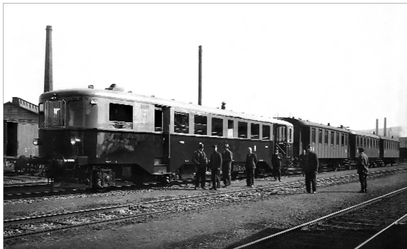
574. Sanok. Wagon motorowy 3 klasy SCgx90 092, wyprodukowany w sanockiej fabryce na licencji węgierskiej firmy Ganz (zespół napędowy typu „Ganz-Jendrassik”), z pociągami osobowymi przygotowanym dojazd próbnych. Ok. 1936 r. (fot. ze zb. Zbigniewa Osenkowskiego)
